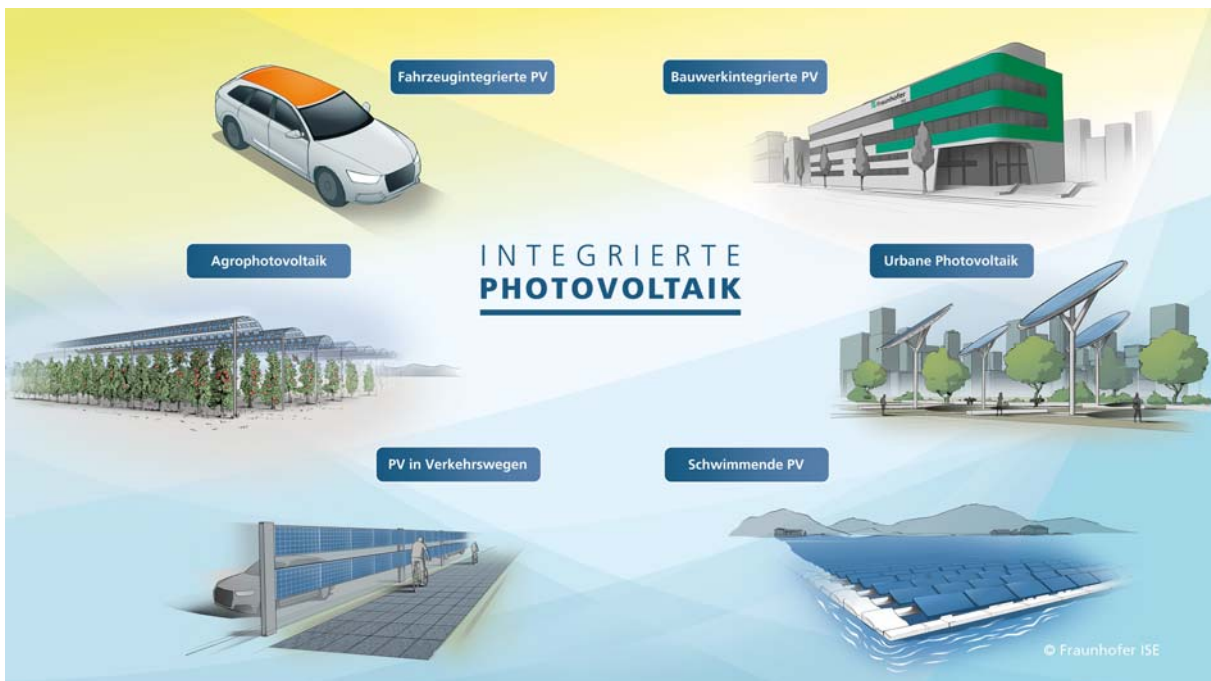
Abbildung 30: Anwendungen für die Integration von Photovoltaik
