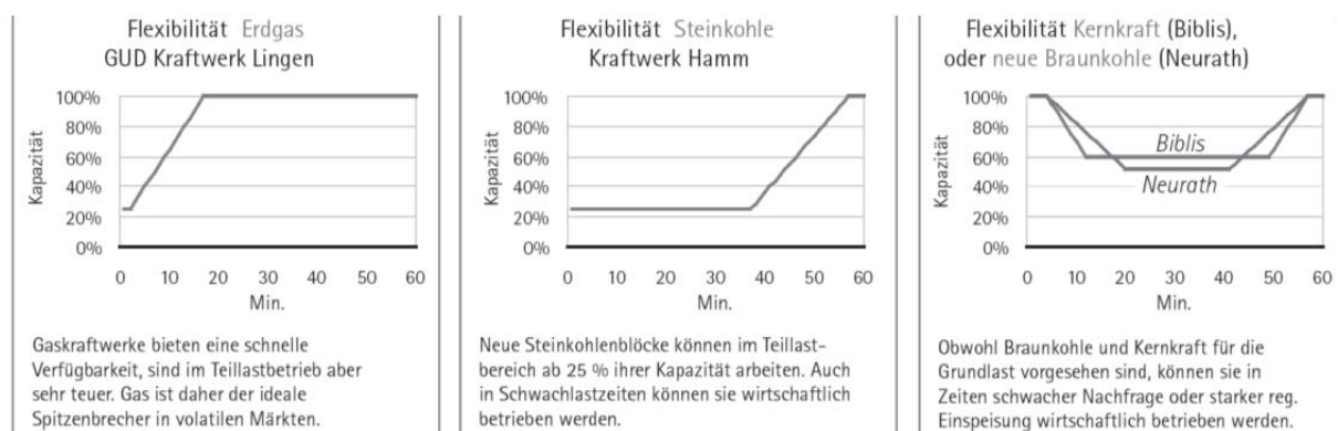
Abbildung 53: Verfügbarkeit von Kraftwerken [VGB]
