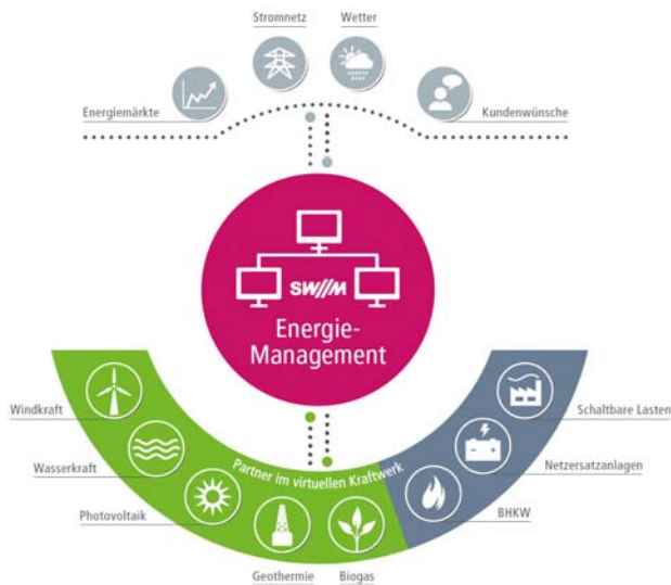
Abbildung 19: Konzept für ein virtuelles Kraftwerk der Stadtwerke München [SWM]
